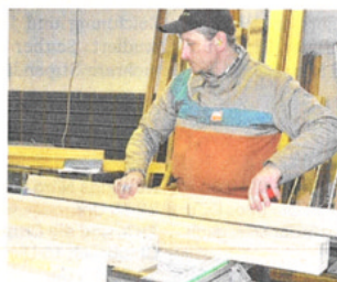
Beim Auflegen der Hölzer muss die vorgebene Reihenfolge strikt eingehalten werden. Die Maschine ist danach eingestellt.
